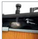
Grote paneelfilter met manuele filterreiniging
